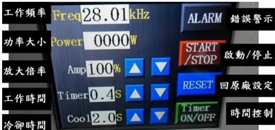
1. 電源開關：往上電源ON(I按下)，超音波工具裝妥狀態，自動追頻於5秒內完成。
